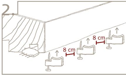
Das LED-Band mit Hilfe der anliegenden Nagel-Clips befestigen. Die Nagel-Clips werden mit einem Abstand von 8 cm montiert.
