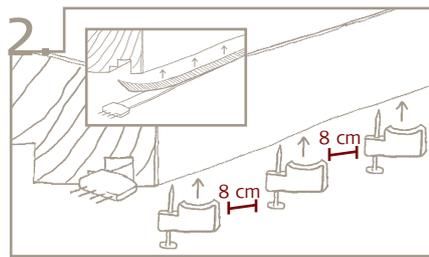
Das Papier auf der Rückseite des LED-Bandes entfernen. Mit Hilfe des Klebebandes\* das LED-Band unter der Abschlussprofil des Zauns befestigen. Das LED-Band mit den anliegenden Nagel-Clips befestigen. Die Nagel-Clips werden jeweils mit 8 cm Abstand montiert.
