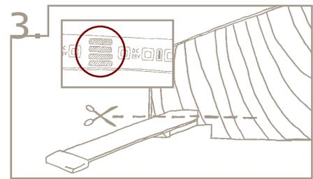
Bei der Montage des Eck-Steckers am Zaun-Ende – am anderen Ende der Stromversorgung – das Papier auf der Rückseite des LED-Bandes entfernen und – mit Hilfe des Klebebandes – das LED-Band fest unter dem Abschlussprofil des Zauns befestigen – siehe Foto 2. Die Länge des LED-Bandes anpassen – wird mit dem abschneiden des überschüssigen LED-Bandes gemacht. Das LED-Band wird dort abgeschnitten wo die sichtlichen Lötungen sind.
