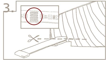
Überschüssiges LED-Band am anderen/entgegengesetzten Ende der Stromversorgung abschneiden. LED-Band kann auch mit 20 cm Pass-Stücken\* angepasst werden. Das LED-Band wird an den sichtbaren Lötungen abgeschnitten.
