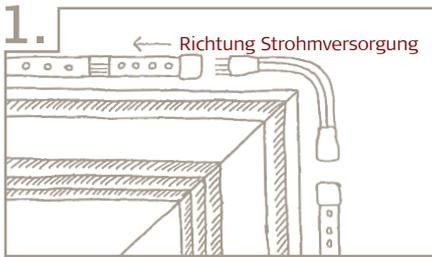
LED-Band an beiden Seiten des Eck-Stückes befestigen und das Eck-Stück\* unter dem Abschlussprofil an der Zaun-Ecke montieren. WICHTIG – das LED-Band – das gegen die Stromversorgung verläuft – da muss der Stecker gegen die Stromversorgung angebracht werden. Den Abstand vom Eck-Stück bis zum Zaun-Ende wo die Stromversorgung ist abmessen. Das LED-Band mit 20 cm Pass-Stück anpassen.
