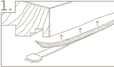
Das Papier auf der Rückseite des LED-Bandes entfernen. Mit Hilfe des Klebebandes\* das LED-Band unter dem Abschlussprofil des Zauns befestigen. Die Montage am Ende der Stromversorgung beginnen.
